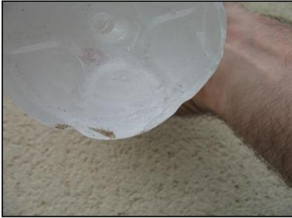
Constatation d'une augmentation de la turbidité à partir de 42 m3/h avec apparition de grains fins (turbidité solide)
